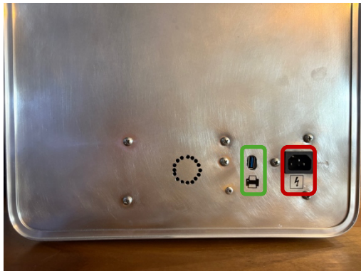
220V Stromanschluss USB- Anschluss für Drucker
