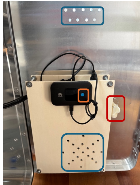
Router EIN/AUS Lüftungsschlitze Schlüssel (für Montage auf Stativ)
